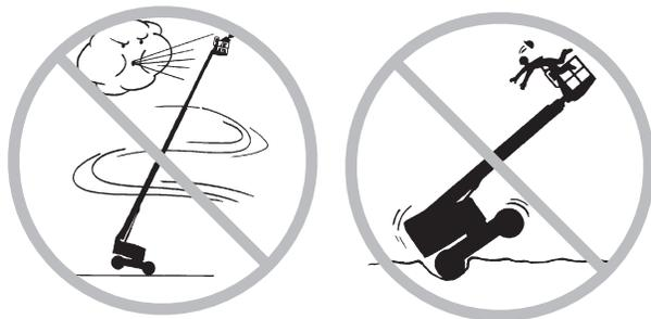
Faire preuve d'une extrême prudence et rouler lentement en conduisant la machine en position repliée sur un terrain irrégulier, des débris, des surfaces meubles ou glissantes ou près de trous et de dévers.
