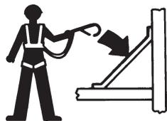
Les occupants de la nacelle doivent porter une sangle ou un harnais de sécurité et se conformer aux réglementations officielles en vigueur. Attacher la longe de sécurité au point d'ancrage prévu à cet effet dans la nacelle.
