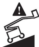
**Modèles ANSI, CSA et AUS :** le témoin allumé indique que la machine est inclinée. L'alarme de dévers retentit lorsque ce témoin est allumé. Placer la machine sur une surface ferme et plane. Déterminer la position de la flèche sur la pente, comme illustré ci-dessous. Abaisser la flèche conformément aux instructions avant de déplacer la machine sur une surface ferme et plane. Ne pas faire pivoter la flèche en l'abaissant.
