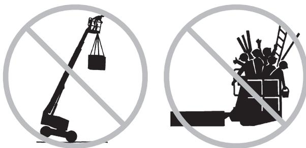
Ne pas placer d'échelle ni d'échafaudage dans la nacelle, ni contre une partie de la machine.
